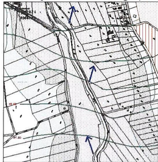
Le **sens d'écoulement** des eaux est considéré comme parallèle au cours d'eau ou, lorsque l'on en dispose, perpendiculaire à la ligne d'isocote de référence reportée sur la carte des aléas, sauf indication chenal de crue.
